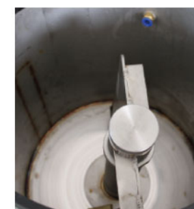
自动搅粉装置 Automatic mixer installation
