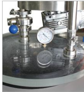
进口透明加厚亚克力板和全硅胶密封圈加大下桶
