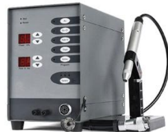
100A自动式点焊机 100A Automatic Spot Welder 型号 Model: M.SW.00023 电压 Voltage: 220V/50hz 焊接电压 Solder Voltage: 40V 焊接电流 Solder current: 5A-600A 焊接时间 Solder time: 3ms-30ms
