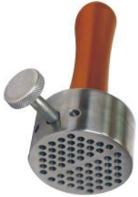
手批戒指夹 Hand ring clamp T.GI.1023-5 0.8KG
