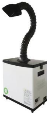
型号 Model: M.SW.PD108 电压 Voltage: AC220V 50Hz 功率 Power: 150W 风量 Air volume: 300m 3 /h 进风口法兰 Air inlet flange: \Phi 75mm 尺寸 Size: 420x245x480mm 重量 Weight: 18KG
