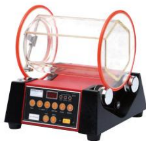
电子滚动抛光机KT-250 Electronic barrel polishing machine KT-250 型号 Model: M.MT.GT004
