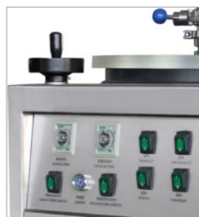
1.5mm厚不锈钢一体式机箱及防水操作按钮
