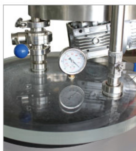
进口透明加厚亚克力板和金硅胶密封圈加大下桶
